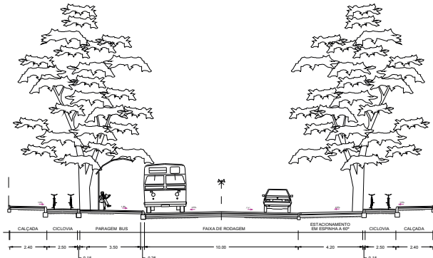
Via Urbana Estruturante - Perfil Tipo com paragem de transportes coletivos e estacionamento
